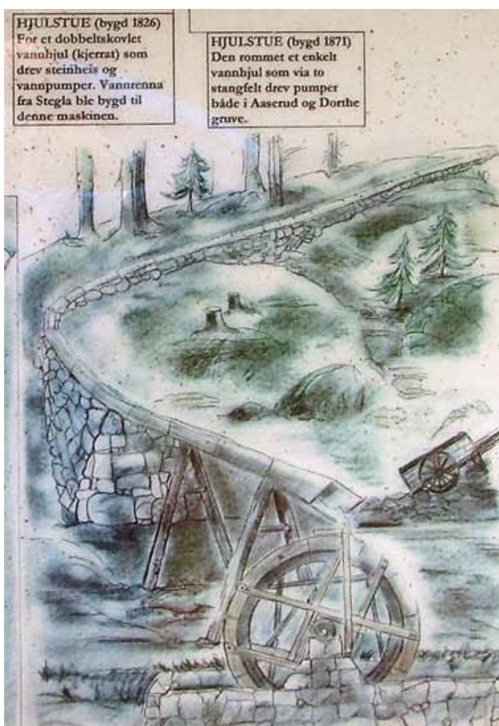
Hjulstue bygd i 1826. For et vannhjul (kjerrat) som drev steinheis og vannpumpe. Vannrenna fra Stegla ble bygd til denne maskinen.
